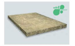
Power-teK BD es un panel de aislamiento de lana mineral de roca, optimizado para aplicaciones con alta temperatura, que posee excelentes valores de conductividad térmica. Se usa como solución universal para superficies niveladas y amplias. El panel tiene una temperatura máxima de servicio de 640°C.
