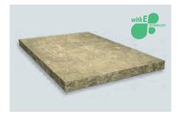
Power-teK BD es un panel de aislamiento de lana mineral de roca, optimizado para aplicaciones con alta temperatura, que posee excelentes valores de conductividad térmica. Se usa como solución universal para superficies niveladas y amplias. El panel tiene una temperatura máxima de servicio de 700°C.
